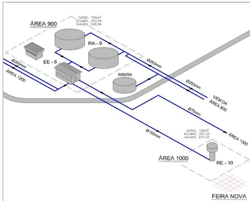
Figura 7 - Sistema de Abastecimento de Água
