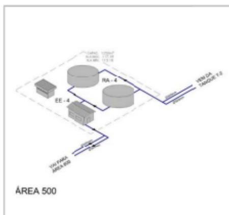
Cada unidade de reservação possui diâmetro de 20,70 m e as cotas de nível d'água máxima e mínimo de 117,16 m e 113,16 m, respectivamente.
