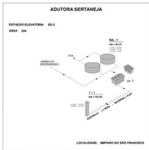
O processo de tratamento utilizado é o simplificado, tipo filtração direta de fluxo ascendente com seis unidades filtrantes operando sob regime de taxas declinantes variáveis, pré-fabricadas em resina reforçada com fibra de vidro (RRFB).
