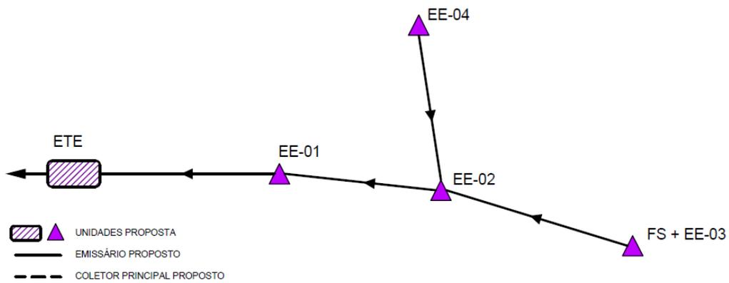
Figura 8 - Sistema de interligação das elevatórias
