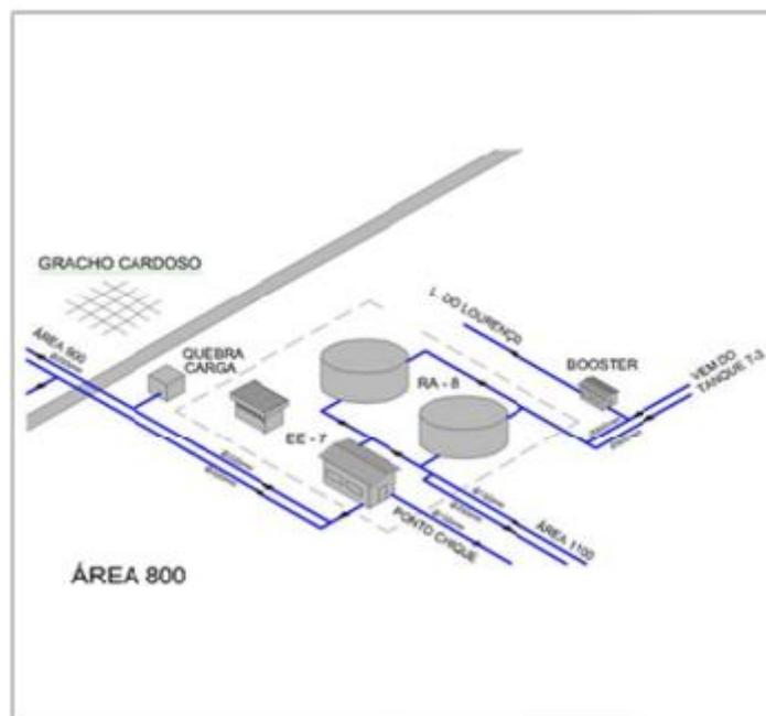
Cada unidade de reservação possui diâmetro de 18,0 m e as cotas de nível d'água máximo e mínimo de 268,58 m e 264,58 m, respectivamente.
