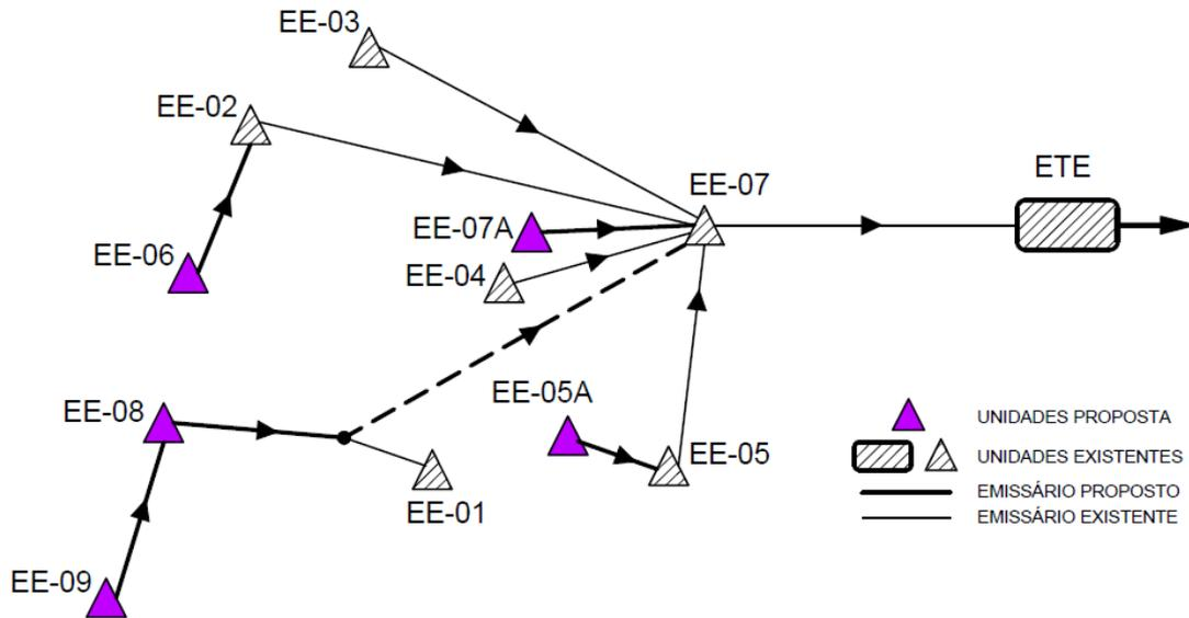
Figura 10 - Sistema de interligação das elevatórias
