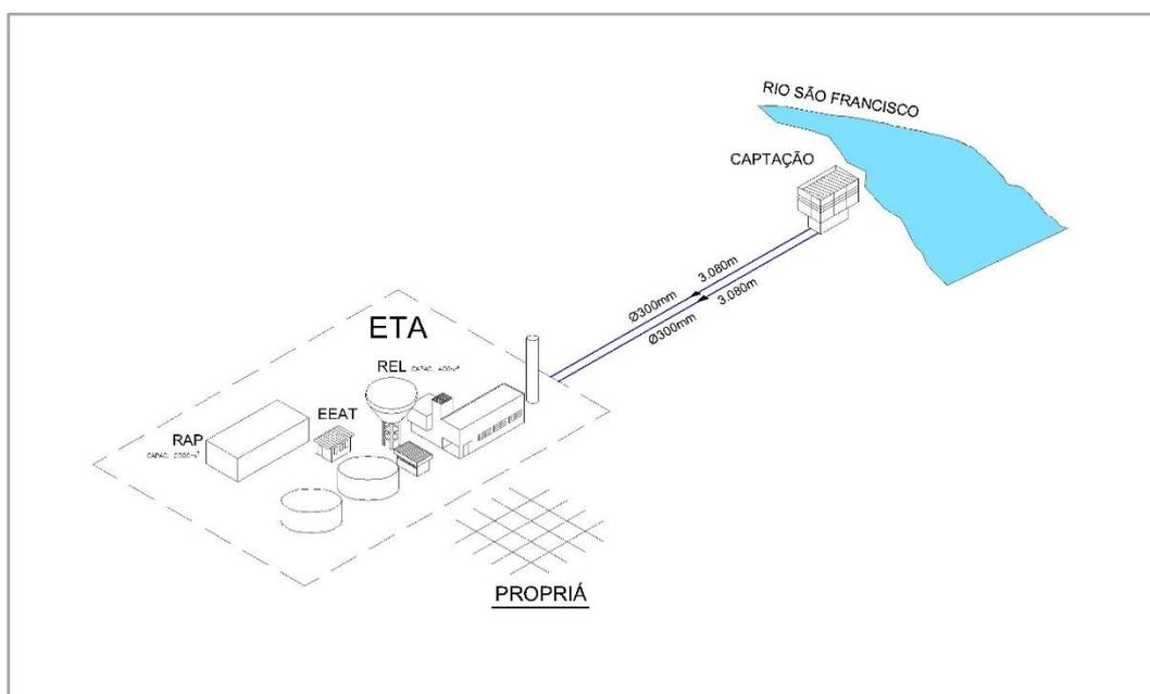
Figura 8 - Sistema de Abastecimento de Propriá
